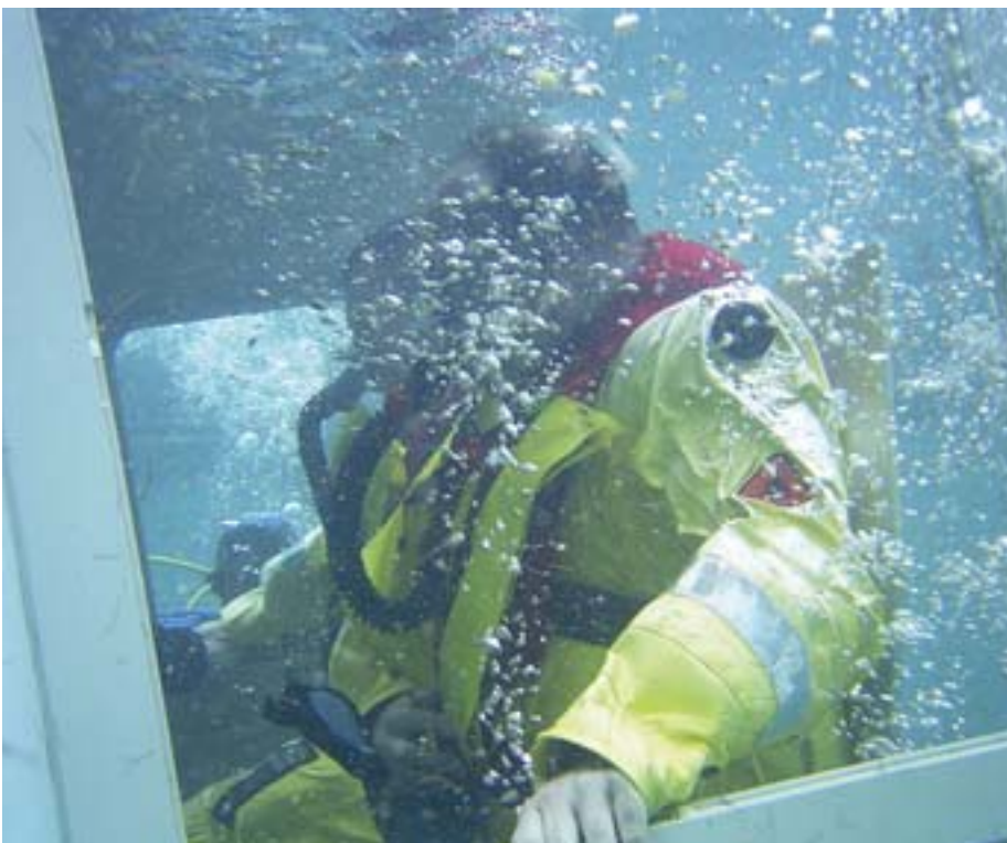
➤ Alumnos utilizando el equipo de respiración de emergencia, preparados para liberarse de sus arneses y evacuar el simulador.
