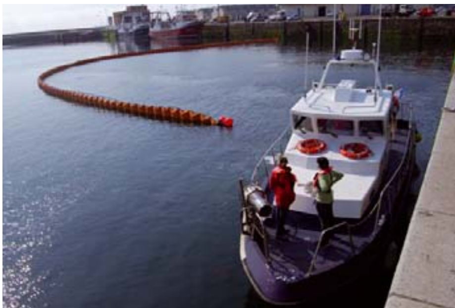
► Durante el ejercicio se desplegaron varias barreras para contener la supuesta contaminación.
