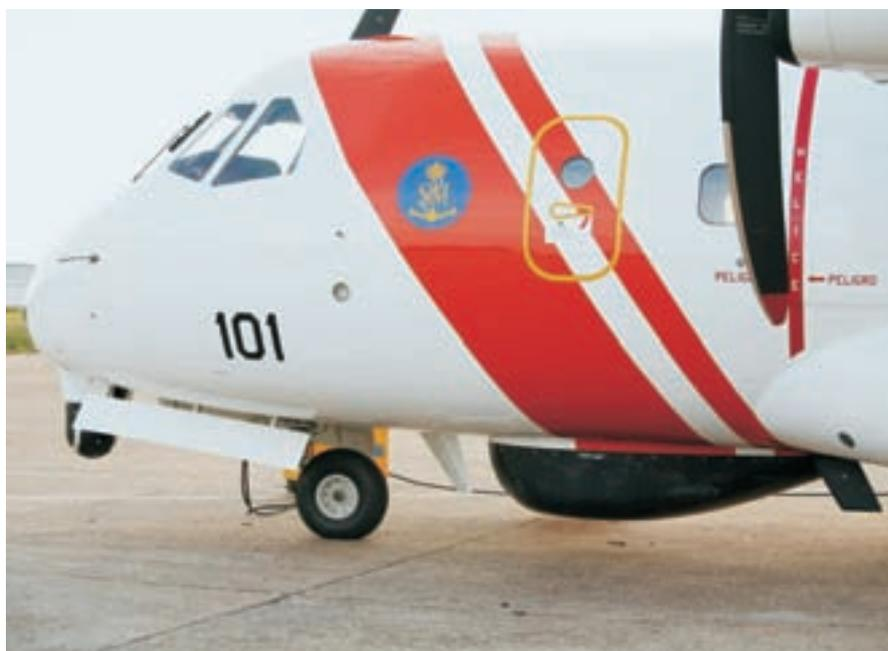
▲ Bajo el morro del avión puede verse la torreta FLIR y detrás de la rueda el domo del radar de búsqueda. Son dos de los sistemas fundamentales en las tareas de búsqueda y salvamento y en las de control de tráfico marítimo. (Foto: EADS CASA).
