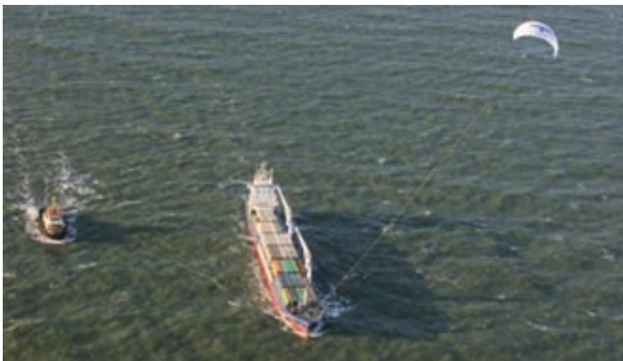
▲ Operadas mediante ordenador, las cometas son capaces de economizar hasta el 35 por 100 del combustible en una singladura, reducen el esfuerzo de la máquina principal y disminuyen los costes de su mantenimiento.
