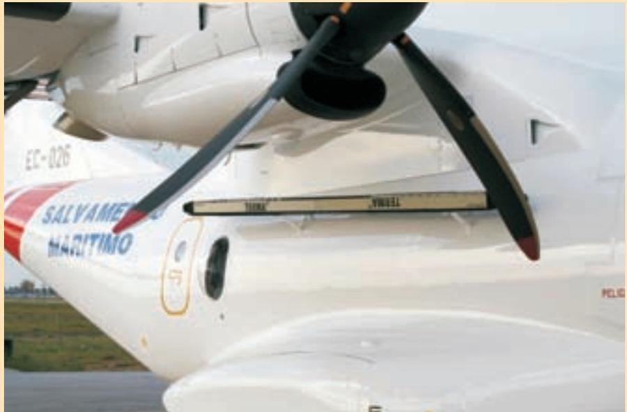
▲ Tras las palas de la hélice del turbopropulsor derecho se puede ver la antena del radar SLAR y, al lado del portillo de salida de emergencia, una de las ventanas dotadas con burbuja de observación. (Foto: EADS CASA).
