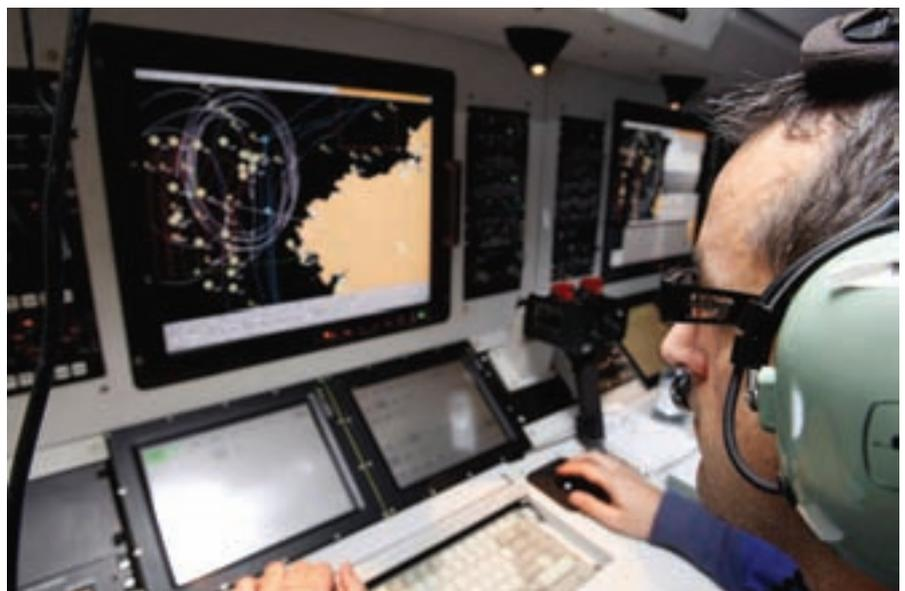
▲ El avión va dotado con un radar anticontaminación, que barre veinte millas a cada lado del aparato mediante dos grandes antenas.
