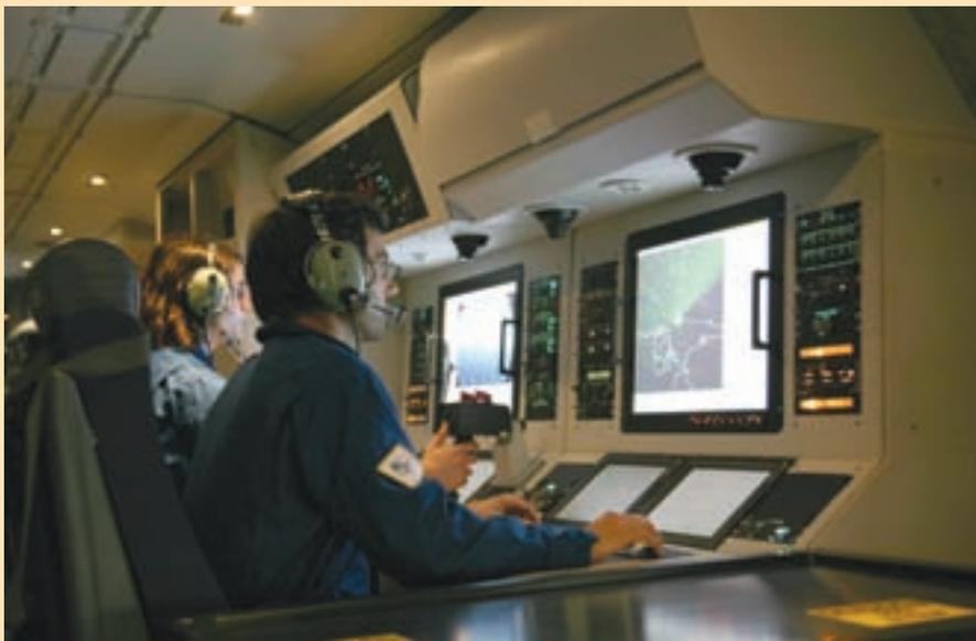
▲ Vista de dos consolas del sistema FITS con sus pantallas planas de 20 pulgadas. (Foto: EADS CASA).
