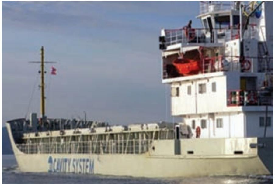
▲ Las pruebas de lubricación del casco mediante burbujas de aire (Air Cavity System), llevadas a cabo con un buque de carga general de 83 metros de eslora, muestran sensibles economías de combustible.
