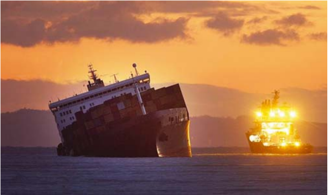
▲ El portacontenedores “Napoli” varado voluntariamente por orden del SOSREP el 20 de enero de 2007 en Lyme Bay, costa meridional del Reino Unido, para evitar su hundimiento.
