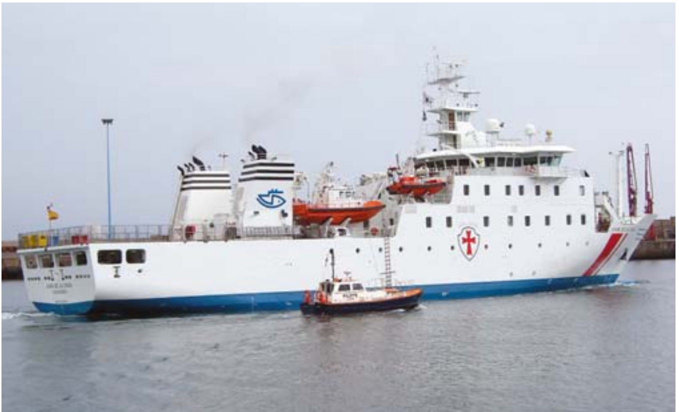
▲ El “Juan de la Cosa”, visto por estribor, con una embarcación de prácticos abarloada. El espacio despejado a popa de las chimeneas es la pista para helicópteros. (Foto: MTAS.)
