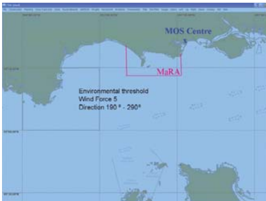
▲ Escenario geográfico de la demostración en el canal de la Mancha, con representación de una ZoRMAR (Zona de Riesgos MarNis) activada a partir de un umbral de viento superior a fuerza 5 proveniente de un sector entre el 190 y 290. Obsérvese la situación del Centro SOM en Highcliffe.
