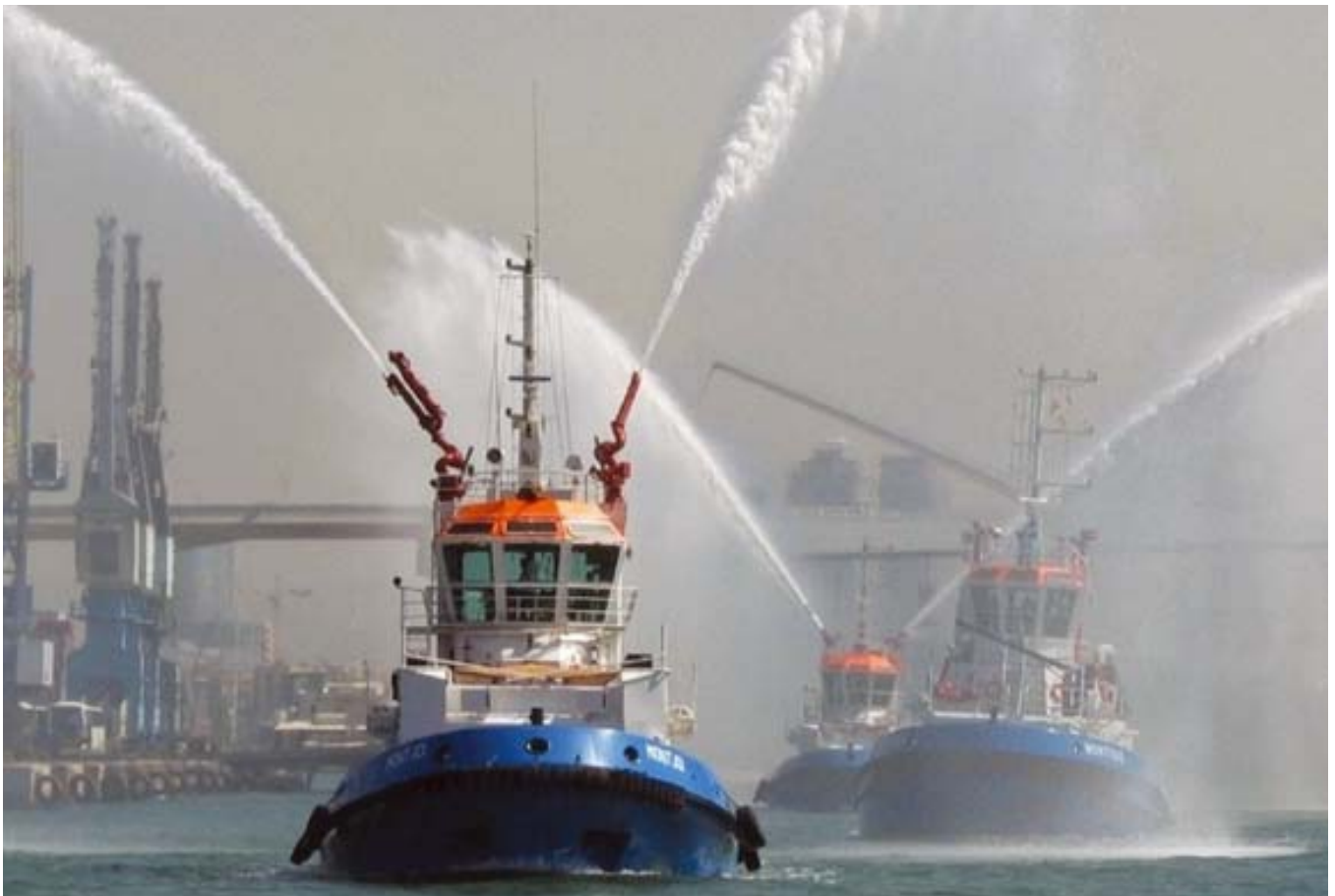
▲ Un grupo de remolcadores probando sus sistemas contraincendios.
