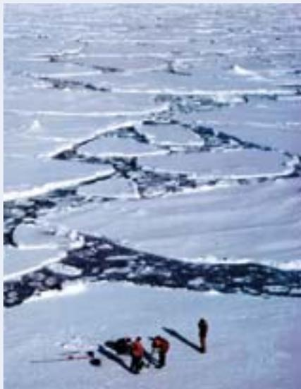
Midiendo el espesor del hielo flotante con una sonda helicoidal.
