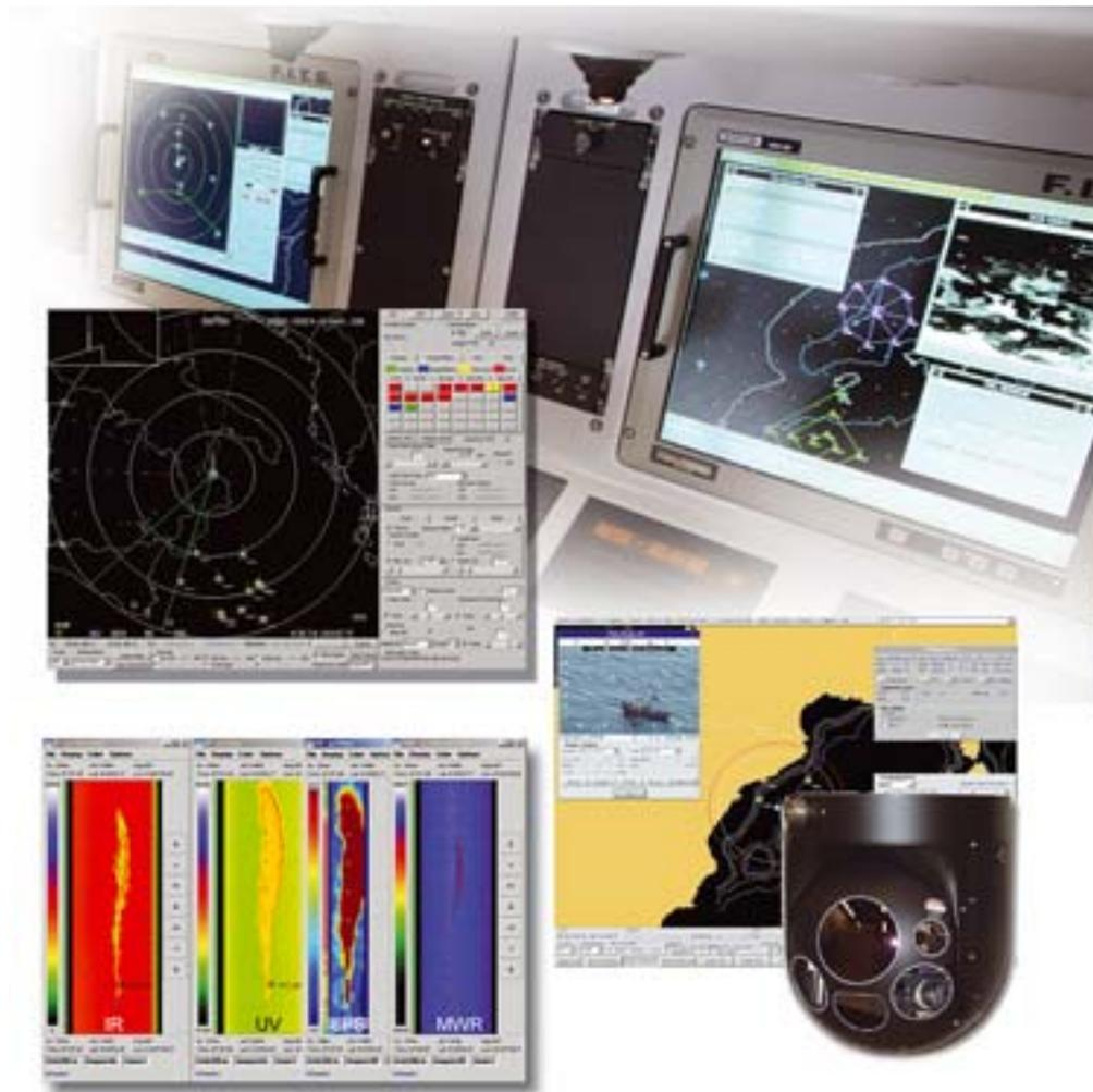
▲ El CN-235 está equipado con dos consolas de misión (al fondo) para la operación del radar de búsqueda, del sistema de control de contaminación marina (abajo a la izquierda) y de la cámara de infrarrojos/TV (a la derecha).
