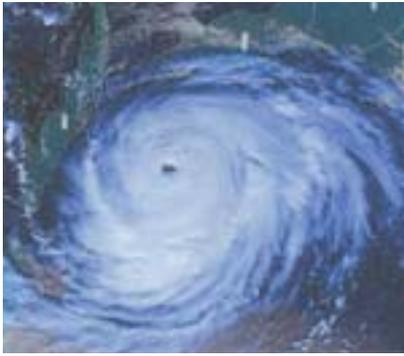
Foto del huracán Floyd sobre el Atlántico, en las islas Bahamas, el 14 septiembre de 1999, con una resolución de imagen de 1,1 kilómetros. Se ha obtenido con el escaneador AVHRR, que va a bordo del MetOp, experimentado con los satélites de órbita polar de NOAA. El AVHRR explora la superficie terrestre con seis canales (tres en el visible e infrarrojo cercano y tres en el infrarrojo térmico, enfriados a 105° K). (Foto NOAA.)
