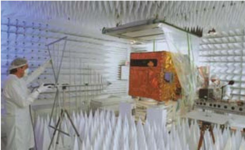
**IASI, el interferómetro de infrarrojo durante las pruebas de laboratorio en Alcatel.**
