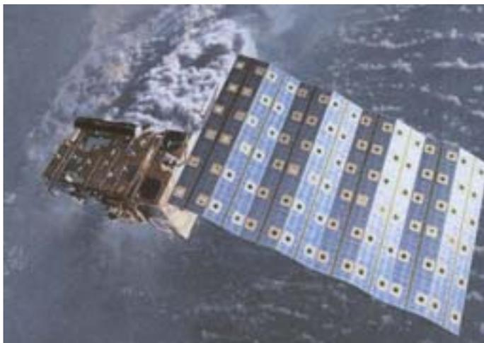
MHS tiene dos canales: **H1** a 89 GHz y **H2** a 157 GHz. Ambos detectan el vapor de agua en las capas inferiores de la atmósfera. Los demás canales, H5 (190,3 GHz) y H4 (183,3 GHz) miden el vapor de agua en capas superiores de la atmósfera. Cuando el MetOp apunta al nadir observa un área circular de un diámetro de 16 kilómetros. Los datos del MHS se utilizan para la Previsión Numérica del Tiempo.
