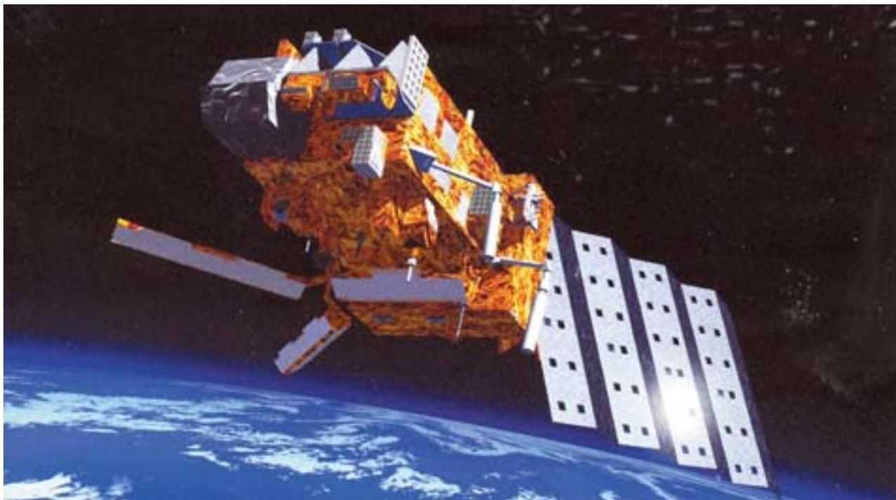
El MetOp en órbita polar. A la izquierda, las tres antenas del ASCAT; a la derecha, los paneles fotovoltaicos. (Foto EUMETSAT.)
