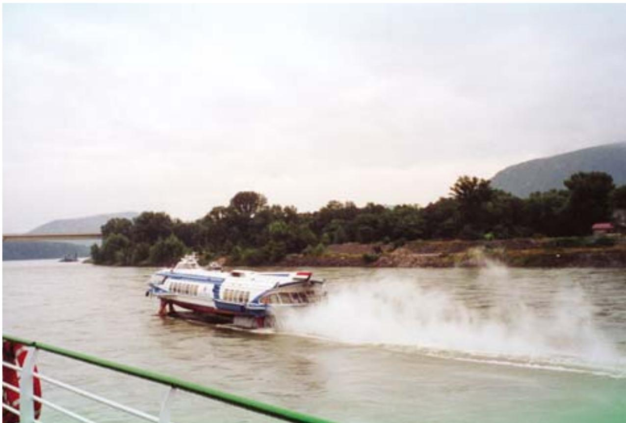
El "Solyom II", navegando por el Danubio a toda velocidad, muestra sus alas semisumergidas.
