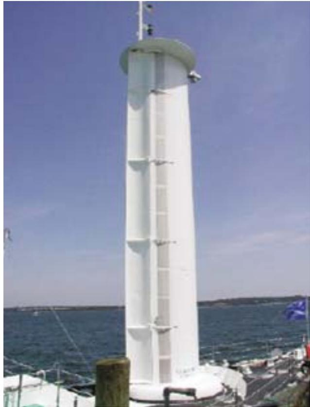
Figura 7. El buque "Alcyone" en navegación empleando como sistema de propulsión su dos *turbosails* (izquierda) y una vista de costado de uno de sus *turbosails* (derecha). Fuente: <http://colaco.freeshell.org/downloads/alcyone>.
