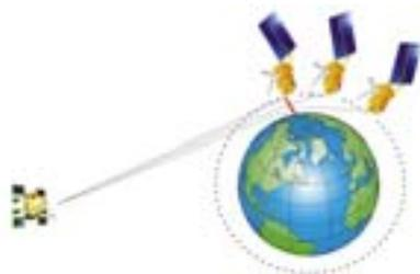
El gráfico muestra el principio de funcionamiento de GRAS, usando la constelación GPS. (Foto EUMETSAT.)
