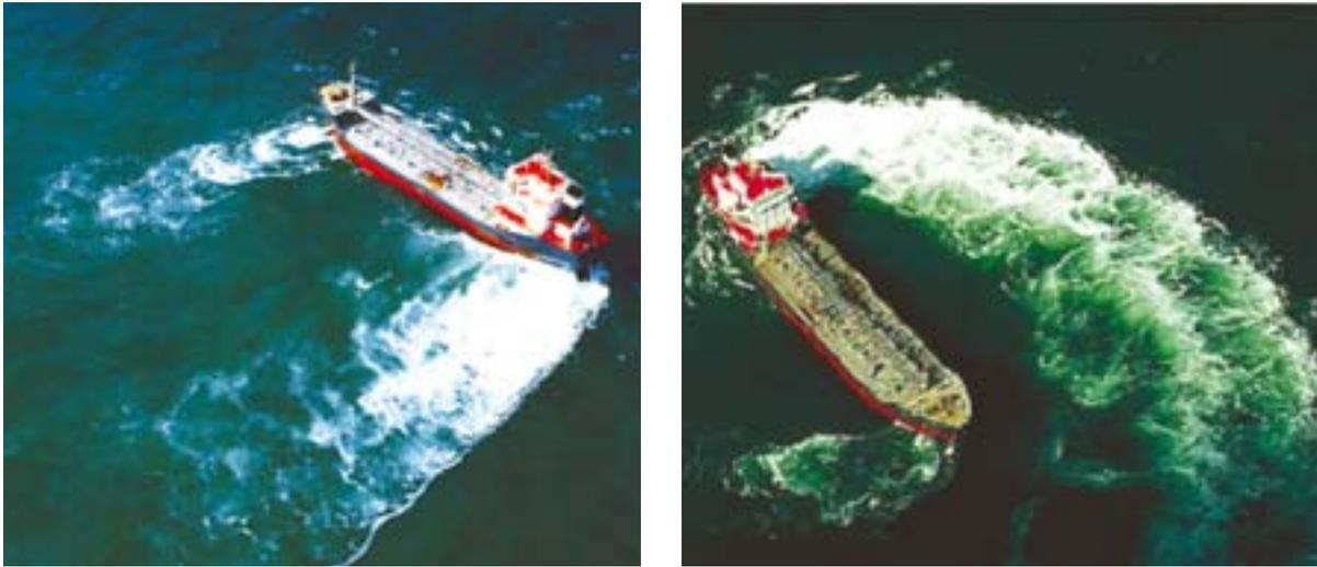
FIGURA 12. El M/V "Esso Plymouth" equipado con un timón Schilling MonoVec desplazándose lateralmente con la ayuda de una hélice lateral de proa (izquierda) y evolucionando prácticamente sobre su eslora (derecha). Fuente: <http://japanham.co.jp/www/en/service/pdf/scilling.pdf>.
