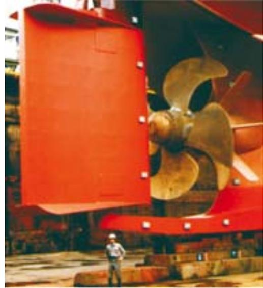
FIGURA 10. Detalle de un timón Schilling MonoVec soportado de que va dotado el petrolero de 68.000 DWT M/V "Hal Dean". Fuente: <http://japanham.co.jp/www/en/service/pdf/scilling.pdf>.
