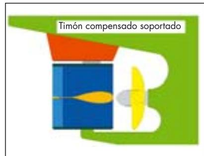
FIGURA 5. Detalle del tipo de soporte de este tipo de timón compensado soportado.
