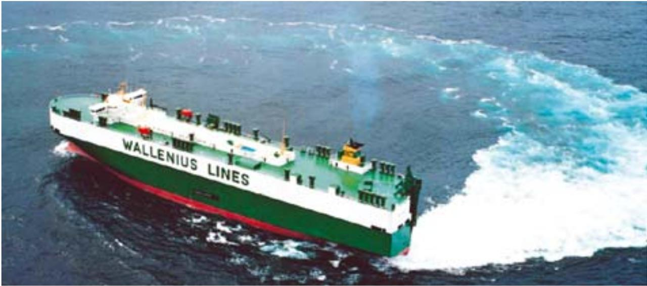
El buque ro-ro "Aida" de la compañía Wallenius Lines, realizando una curva de evolución con 70° de timón a estribor. Este buque va dotado de un timón Schilling MonoVec. Fuente: <http://www.hamworthy.com/docGallery/83.PDF>.
