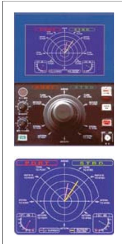
**FIGURA 16.** Detalle de la consola del *joystick* y de la unidad visual de presentación (Visual Display Unit —VDU—) de un sistema de timones Schilling VecTwin, en la que se puede apreciar el vector de empuje ordenado por el *joystick* y el vector respuesta del buque. Ambas tienen iluminación ajustable con el fin de obtener una presentación adecuada para visión nocturna. Fuente: [http://japanham.co.jp/www/en/img/pdf\\_o.gif](http://japanham.co.jp/www/en/img/pdf_o.gif).
