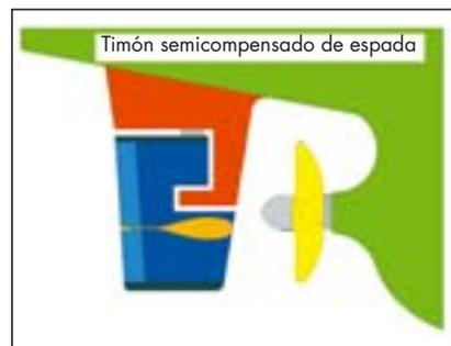
FIGURA 6. Detalle del tipo de soporte de este tipo de timón semicompensado de espada. Se monta principalmente en buques de grandes dimensiones para dotar al timón de un apoyo adicional al objeto de que la mecha del timón pueda resistir los esfuerzos de torsión que se generan evolucionando. Dibujo: autor.
