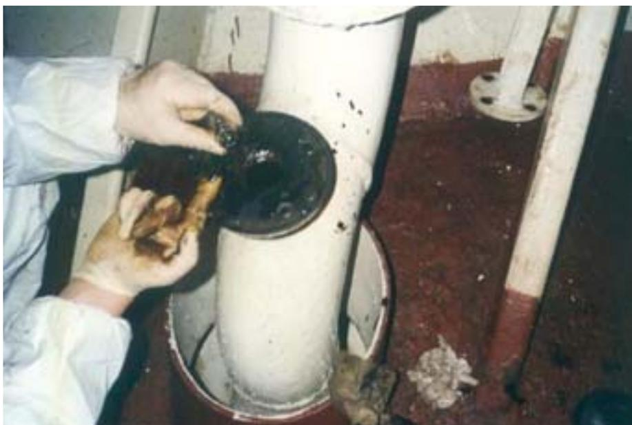
> Desmontaje de la descarga al mar de la bomba de servicios generales que muestra que la descarga de sentinas se ha utilizado en contra de la regla 15.
