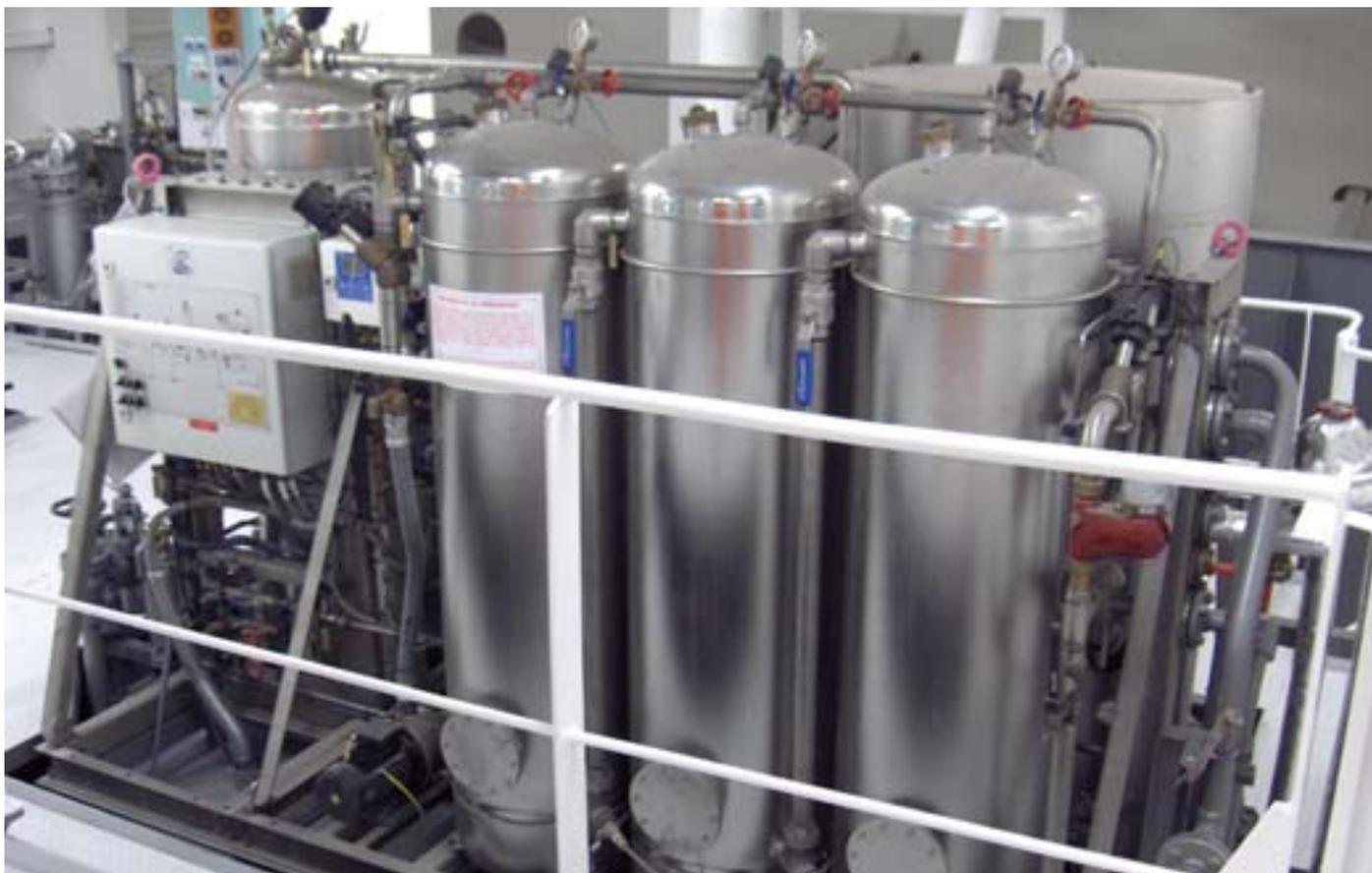
> Equipo filtrador de hidrocarburos en cumplimiento de la resolución MEPC 107 (49).
