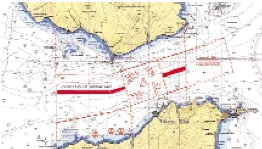
Dispositivo de separación del tráfico marítimo del Estrecho de Gibraltar.
