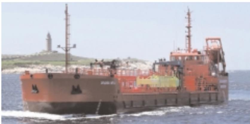
El buque "Urania Mella" está equipado para dar respuesta a derrames de hidrocarburos y actúa como medio recogedor y depósito de las sustancias recogidas, con una capacidad de almacenamiento de 3.100 m<sup>3</sup>.
