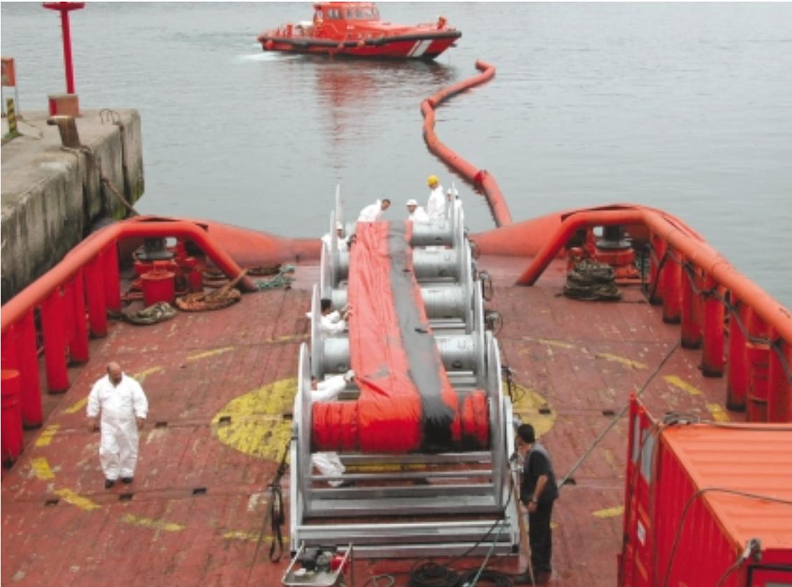
*Despliegue de una barrera oceánica de lucha contra la contaminación.*
