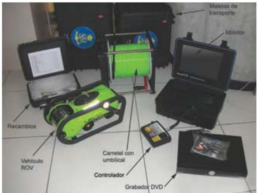
▲ El sistema Seabotix LBV 150<sup>2</sup> al completo, con sus maletas de transporte.
