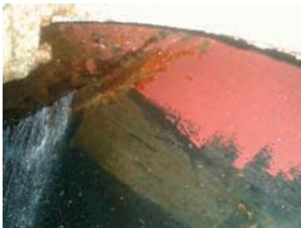
▲ El estudio probabilista de la estabilidad en averías para los buques de carga seca es relativamente reciente. Sin embargo estas averías se presentan con cierta frecuencia, tanto por colisiones, varadas, como por mal mantenimiento y corrosión. La imagen ilustra una avería en cámara de máquinas de un buque de carga debida a corrosión.
