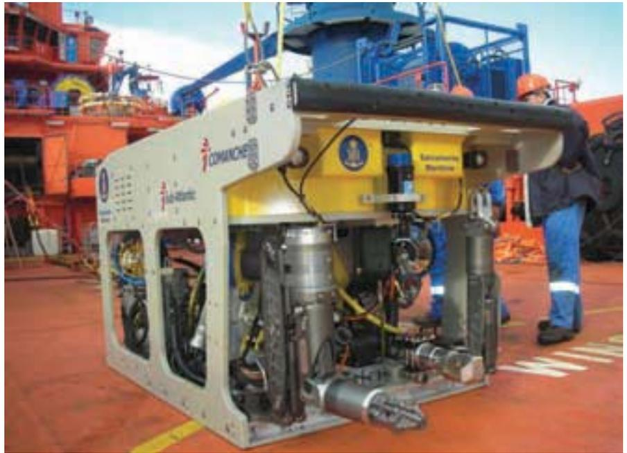
▲ El ROV Comanche, en la cubierta del buque de salvamento “Don Inda”. Se observan en primer término los manipuladores hidráulicos y las cámaras robotizadas.
